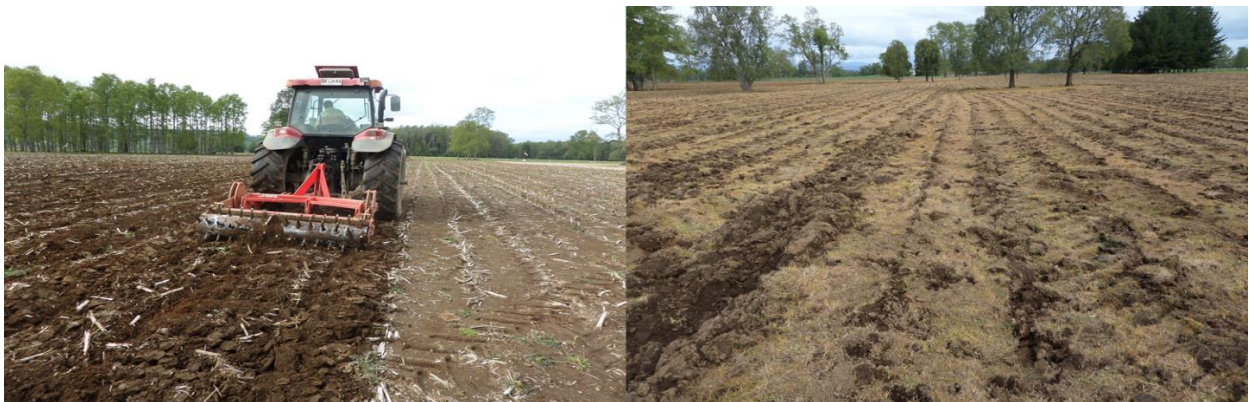
Paso de arado subsolador que permite la descompactación del suelo y la exploración radical del maíz en el suelo.
